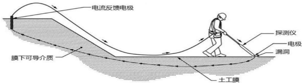
土工膜 (HDPE 防渗膜) 大规模全面检测电火花法: 适用 KODIN-7DJ 土工膜 (HDPE 防渗膜) 泄漏检测仪, 利用蓄电锂电池, 脉冲高压原理通过对土工膜 (HDPE 防渗膜) 表面施加 5~50KV 的高脉冲电压, 探极在土工膜 (HDPE 防渗膜) 表面探扫, 如无火花或报警声视为漏点合格, 出现火花或报警声部位说明有漏洞。
